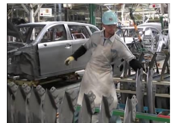
フロントフェンダー取出し作業
