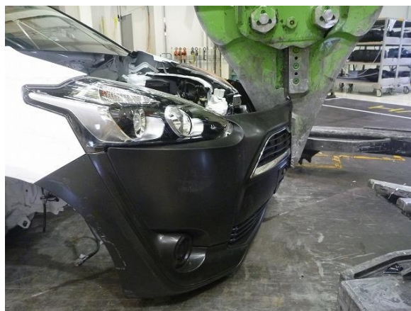
重機によるフロントバンパーの解体評価
