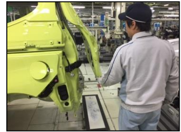
バックドア開け作業
