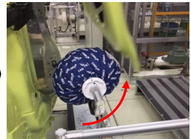
袋（氷のう）に空気を入れるとバックドアがダンパーの力で全開
