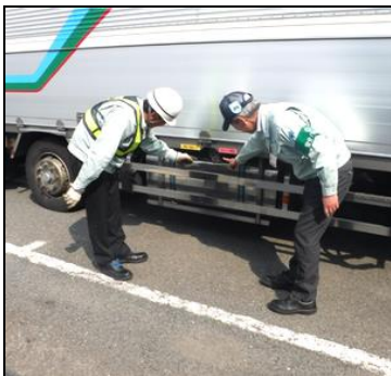
「オイル漏れ」点検の実施
