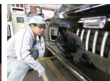
外板面の検査
