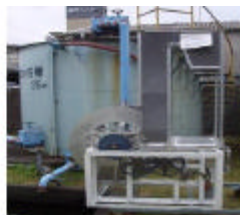
試作2号機(上掛け式) 2012年5月設置トライ予定
