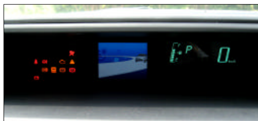
メーター照明にLEDを採用
