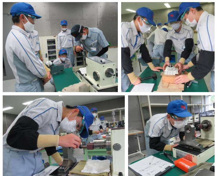
芯出し作業では、ダイヤルゲージを使用して芯のズレを計測し、シムで調整を行っていきます。
