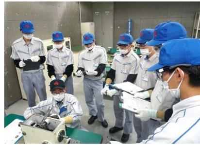
機械要素実習では、「スピンドルボックス」と呼ばれる工作機械の主軸を模した装置の分解・組み付け・調整をおこないます。
