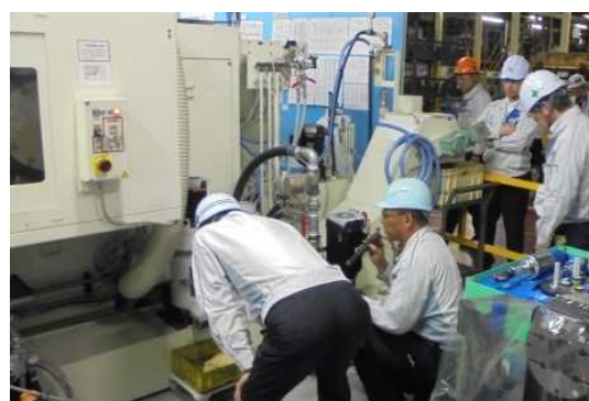
新設備の点検（洗浄油の漏洩防止）
