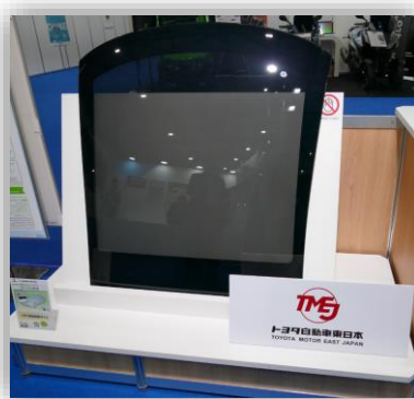
透明樹脂材料の補強技術を使用した ルーフパネル
