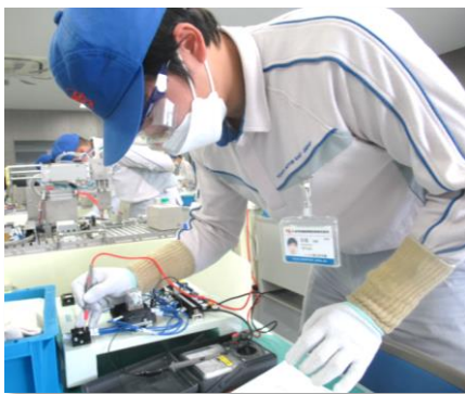
電気図面の見方、異常個所の特定など現場を意識した実習で皆真剣に取り組んでいます。
