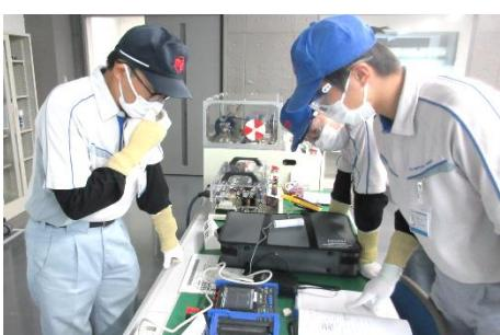
インバータ制御では設定を変更し、モータ回転数や電流・電圧の差を比較し、動作を確認します。
