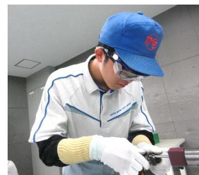
芯出し作業は、ダイヤルゲージを使用するので指先まで集中して作業します。
