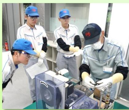
芯出し作業は、ダイヤルゲージを使用するので指先で集中して作業します。
