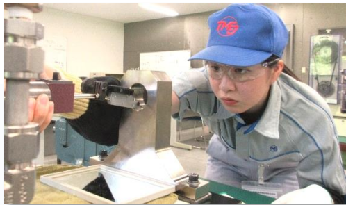
芯出し作業は、ダイヤルゲージを使用して微調整するので、指先まで集中して作業します。
