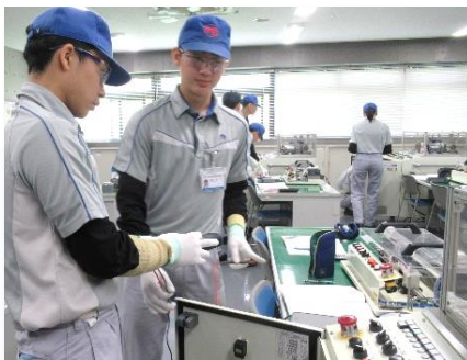
インバータ制御では設定を変更し、モータ回転数や電流・電圧の差を比較し、動作を確認します。
