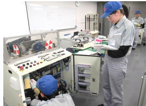
インバータ制御では設定を変更し、モータ回転数や電流・電圧の差を比較し、動作を確認します。
