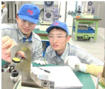
芯出し作業は、ダイヤルゲージを使用して微調整するので、指先まで集中して作業します。
