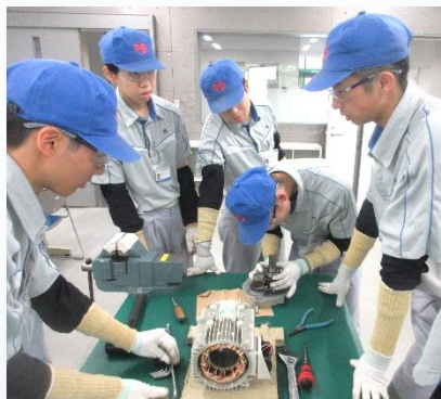
芯出し作業は、ダイヤルゲージを使用して微調整するので、指先まで集中して作業します。
